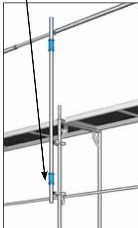
Фиг. 21 и 22: Съвързване на Вертикал за парапет към Speedy рамка
