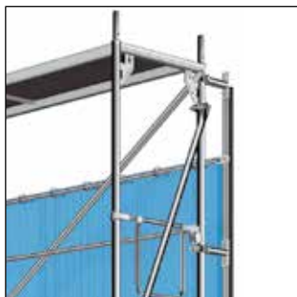
Fig. 130: Пример за монтаж на Keder покривало
