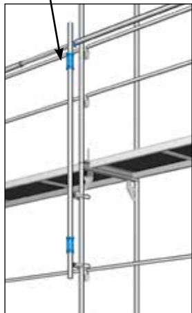
Фиг. 21 и 22: Съвързване на Вертикал за парапет към Speedy рамка
