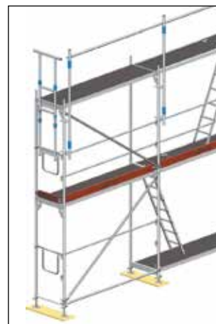
Фиг. 23: Монтаж на (AGS) краен парапет
