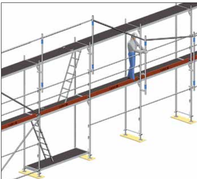
Фиг. 26: Подробно описание на употребата на (AGS) паранет на цяло ниво от конструкцията скеле
