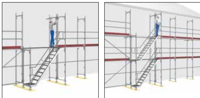
Фиг. 65: Укрепване към основната конструкция скеле
