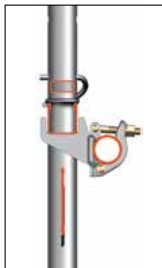
Фиг. 52: Разрез на връзка за анкер
