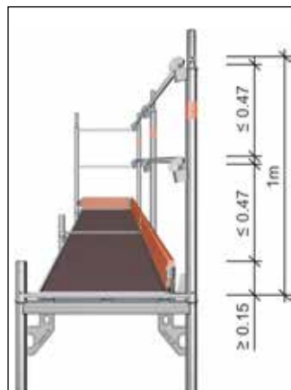
Фиг. 30: Три-съставна странична защита в конструкция скеле SpeedyScaf
